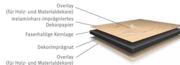
EGGER Kompaktplatten sind Kompakt-Schichtpressstoffe gemäß EN 438-4 und EN 438-8. Eine faserhaltige Kernlage und mit Melaminharzen imprägnierte Dekorpapiere werden unter hohem Druck und hoher Temperatur miteinander verpresst. Kompaktplatten mit Dekordruck (Holz- und Materialreproduktionen) werden mit Overlay produziert.
